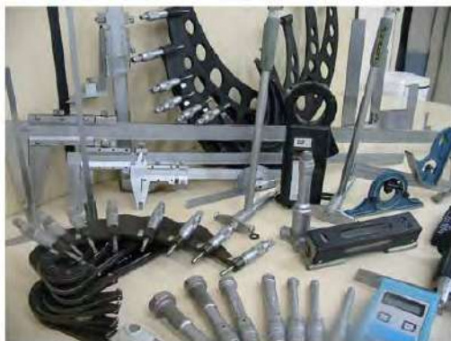
Micrômetro Mitutoyo de 0 a 2000 mm Súbito Mitutoyo de 0 a 500 Paquímetro Universal Mitutoyo de 150 a 2500 mm Relógios comparadores Mitutoyo Goniômetros Mitutoyo
