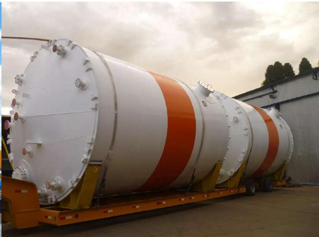
TANQUES DE ALUMINIO PARA ÁCIDO NITRICO
