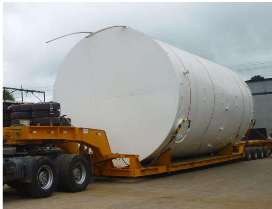
TANQUES DE ÁGUA DE INCÊNDIO 208m<sup>3</sup>
