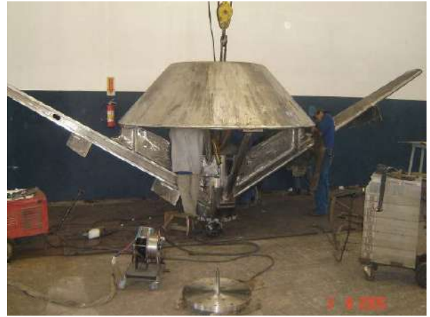
RASPADOR DO DIGESTOR – PRÉ-MONTAGEM Cliente: ARACRUZ
