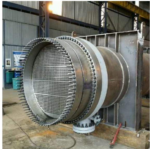
ESPELHO MONTADO COM ANEL DE TESTE PARA TH PETROBRÁS / REPLAN
