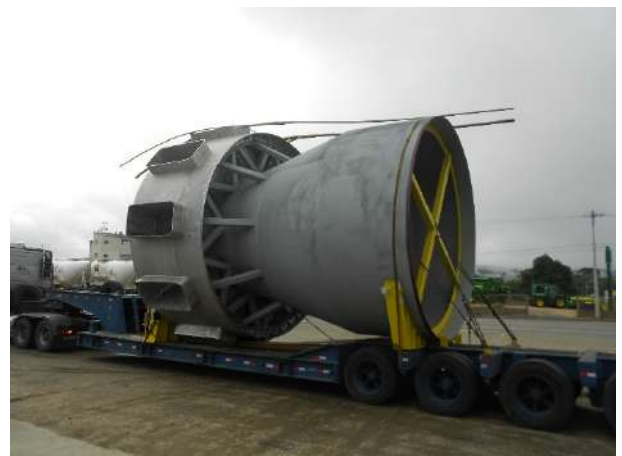
RESFRIADOR DE CAL – “KILN SHELL” PARTE INTERNA EM AÇO CARBONO
