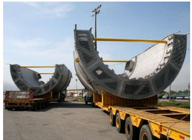
RESFRIADOR DE CAL – “SECTOR COOLER” SEGMENTO PARCIAL (180°) EM INOX 304L
